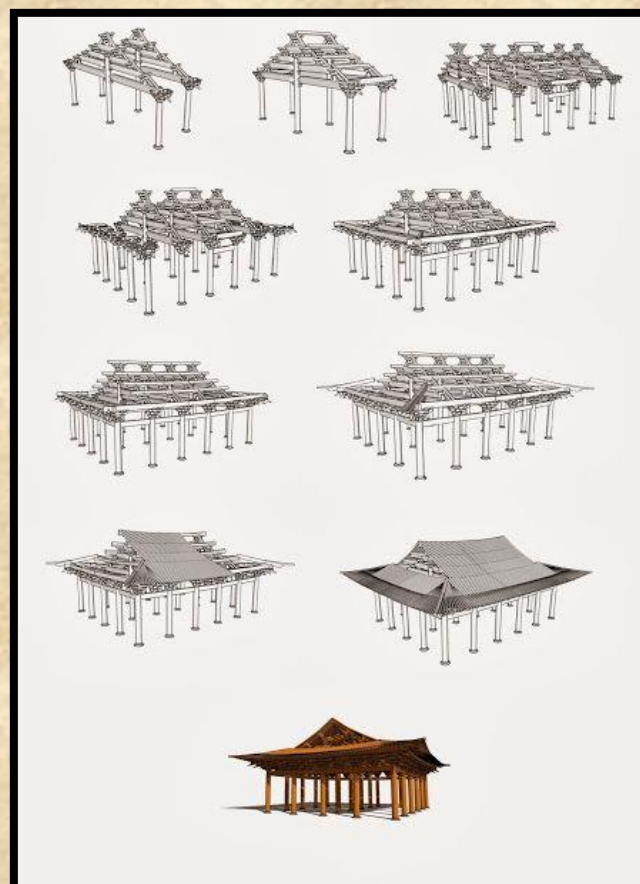
Componentes arquiteturais de uma construção.
