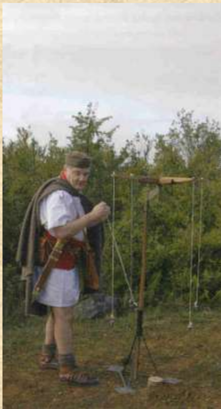
A figura mostra a reconstituição de uma groma.
