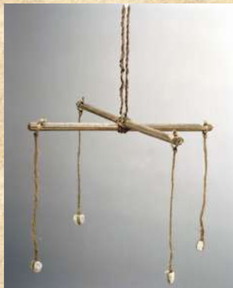
A figura mostra a reconstituição de uma groma.
